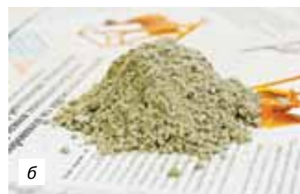
Фото 2. Древесная мука, полученная в аппарате с 20 (а) и 50 (б) пульсационными камерами статора
