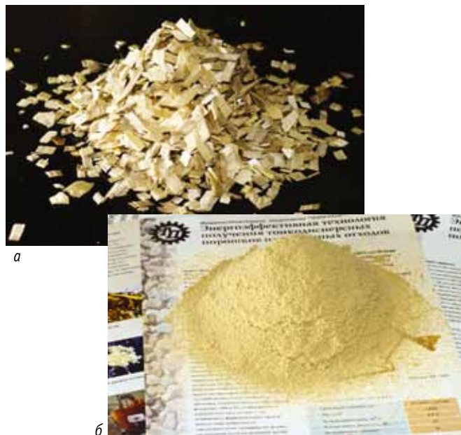
Фото 1. Осиновая щепа с относительной влажностью W = 20\% (а) и полученная из нее мука древесная с размером частиц D_{100} < 560 мкм и W = 0,5\% (б)
