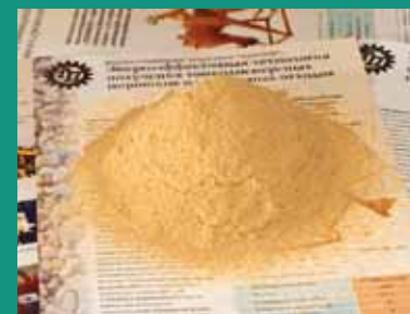
Осиновая щепа W= 20% и полученная из нее древесная D100 < 560 мкм, W= 0.5%
