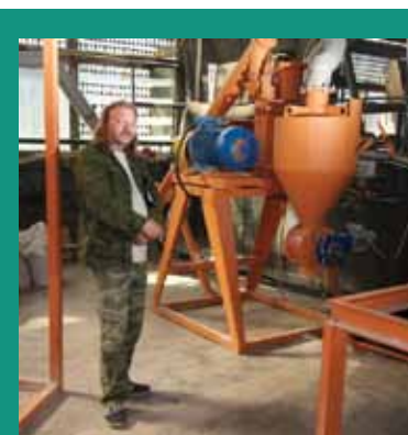
Основной элемент линии сушки-измельчения импеллерная мельница «МИКРОКСИЛЕМА»
