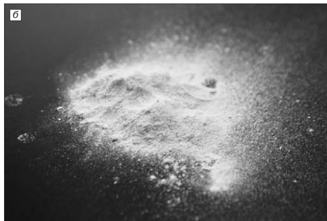
Рис. 2. а – исходный материал – опилки, сучья, ветки \varnothing 30 мм, длина до 20 мм; б – материал после измельчения на импеллерной мельнице «МИКРОКСЕЛЕМА»
