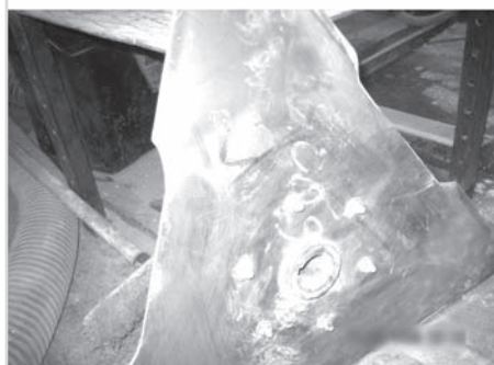
Рис.4 Вихревая мельница и ее ротор. Преобладающий способ измельчения в таком агрегате - истирание
