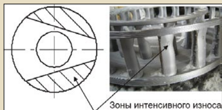
Рис. 3. Ударные элементы втулочного типа в четырехрядном дезинтеграторе
