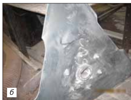
Вихревая мельница (а) и ее ротор после определенного срока эксплуатации (б). Преобладающий способ измельчения в таком агрегате – истирание
