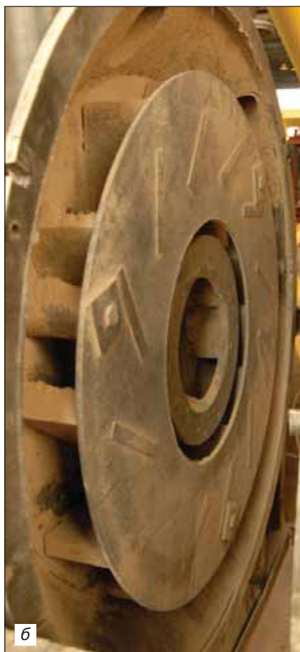
Рис. 5. Принцип действия (а) и внешний вид помольной камеры (б) ударной шаровой мельницы «ТРИБОКИНЕТИКА»
