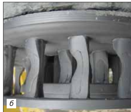
Рис. 2. Схема движения материала в дезинтеграторе (а) и последствия абразивного износа его стержней (б) (коричневые стрелки показывают направление движения измельчаемого материала, черные – направление вращения, серые и голубые – направление движения стержней дезинтегратора с различной окружной скоростью V )
