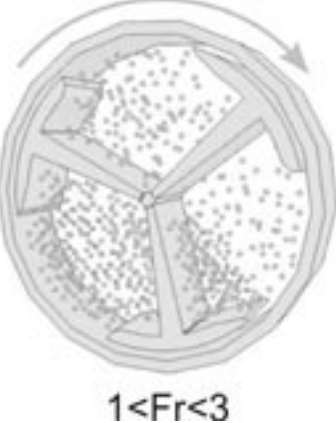
Рис. 2 Среднескоростной режим смешивания
