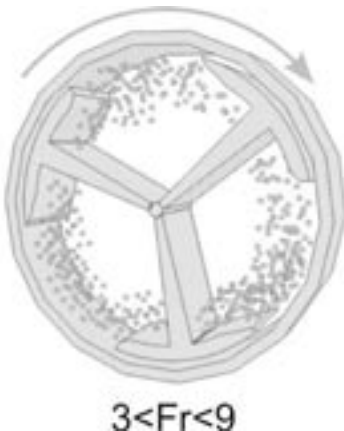
Рис. 3. Высокоскоростной режим смешивания
