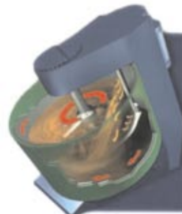
Рис. 6. Работа высокоскоростного смесителя «EIRICH-Intensivmischer» Тип R
